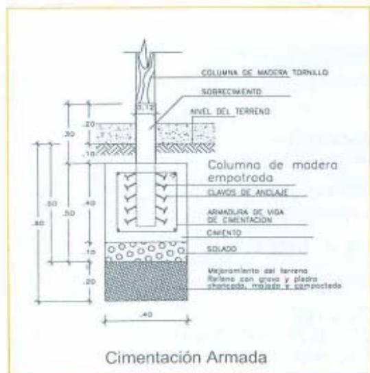
Para la formación del solado se utilizará 1 carretilla de cemento (2 bolsas) x 12 carretillas de agregados.
