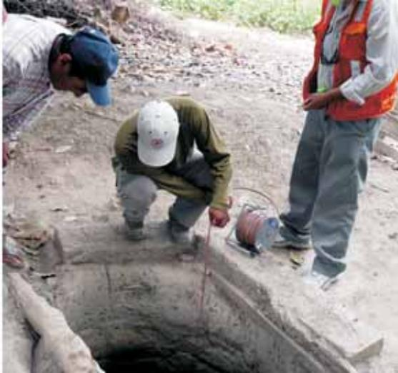
Reconocer sobre qué tipo de suelo se va a construir la casa para definir el tipo de cimentación más apropiada, su ancho y profundidad, las proporciones de los materiales en la mezcla y las dimensiones de las columnas. El mejor suelo para construir es el rocoso o compacto, seco y alto, con respecto a las aguas subterráneas.
