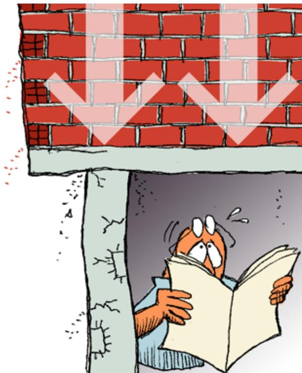
por viviendas construidas con muros de ladrillo industrial tubular, comúnmente conocida como pandereta, que por su estructura con huecos son muy frágiles, casi como una cerámica y se rompen con facilidad en sismos severos. Para muros portantes es necesario usar ladrillos sólidos.
