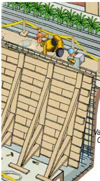
5) Vaciado del muro con concreto fluido tomando muestras del concreto para el control la calidad del mismo, donde la resistencia mínima deberá ser de al menos 210 kg/cm<sup>2</sup>.
