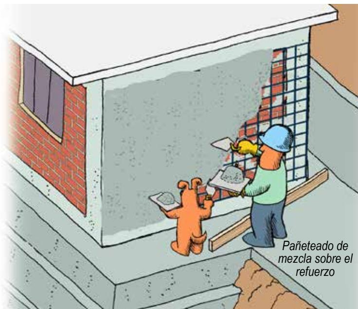
5) Se procede a pañetear con un mortero de 1 de cemento por 4 de arena, para cubrir la malla y lograr un tarrajeo liso del muro, logrando un espesor de recubrimiento de la malla de mínimo 3 cm.
