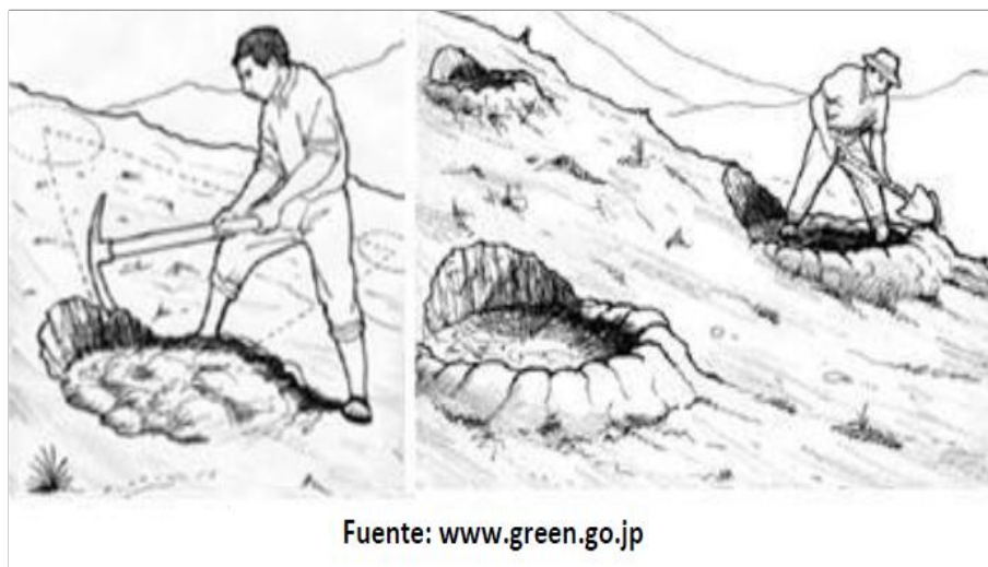
Figura N° 02 Construcción de terrazas
