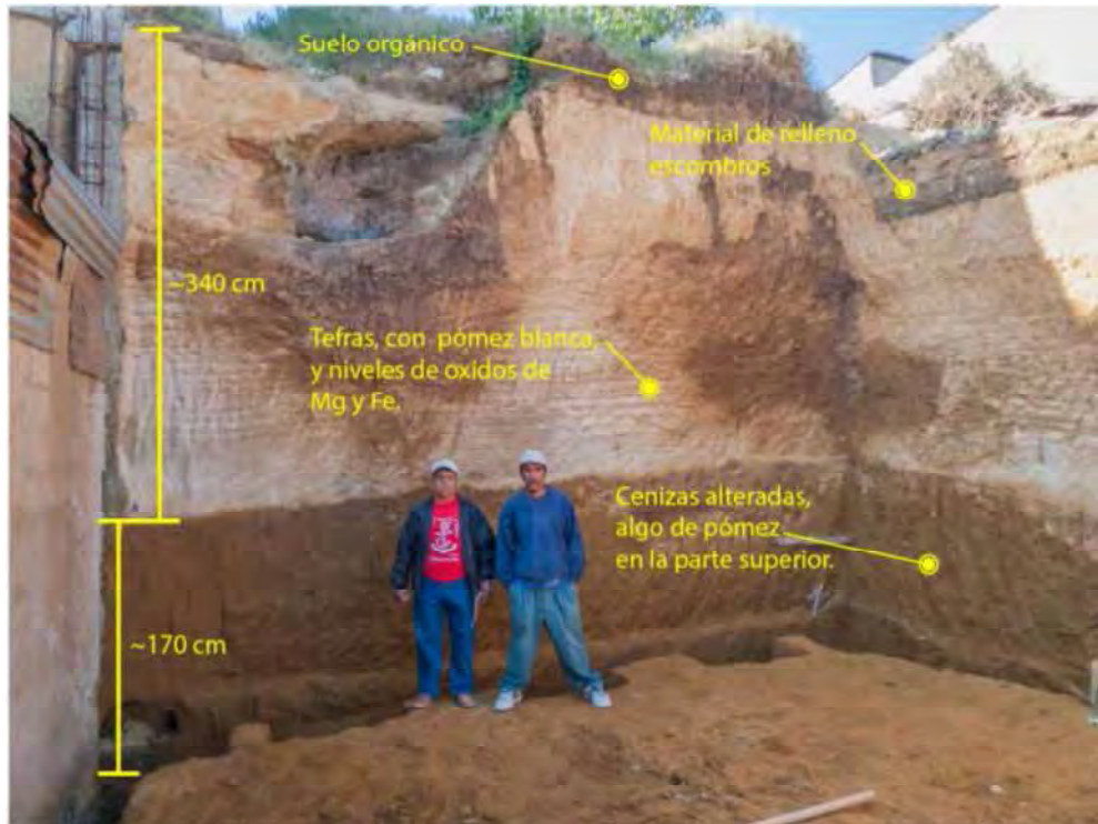
Figura 1. Sección de material aflorando en nivel intermedio de Proyecto Vista de la Comunidad. Se observa una capa inferior de cenizas alteradas (de al menos 170 cm de espesor) sobre la que se va a construir la estructura. Sobre esta capa se observan tefras de caída con un espesor de hasta 340 cm, con pómez blanca y varios niveles ricos en óxidos de hierro y magnetita. Sobre esta capa hay materiales de relleno y una capa de suelo orgánico de unos 20 cm.
