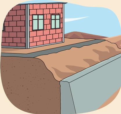
Es importante que el muro tenga una buena cimentación ya que es la base que soportará el peso del terreno. Para la construcción de muros de contención se debe buscar asesoría técnica. Evita la acumulación natural de agua detrás del muro. Para ello, deberás crear canales de drenaje y dirigirlos fuera de casa cuidando de no dañar edificaciones vecinas.
