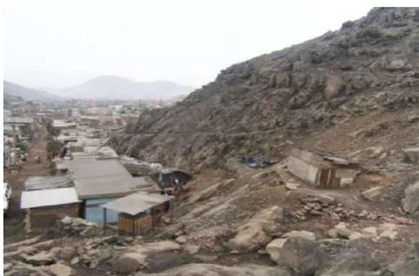
**Foto N.º 38. MATERIAL SUELTO LIMO-ARENOSO,
